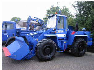
Bergungsräumgerät der FGr Räumen
