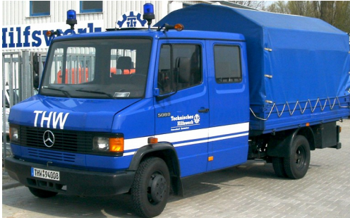
Daimler Benz L508D 58kW (79PS) zul. Gesamtgewicht 4,6t
